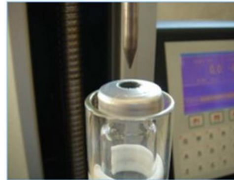
Prüfung der Durchstichfestigkeit an beaufschlagter Probe Bild: IFA
